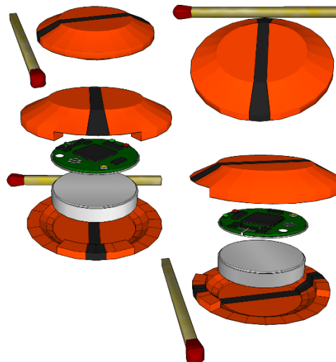
Abbildung 6: 3-D-Modell des zukünftigen INBED-Wearable mit Gehäuse (Version 3) mit einem Streichholz als Referenz (geöffnete und geschlossene Hülle)
