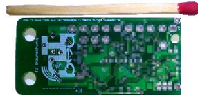
Abbildung 2: Foto der INBED-Platine der ersten Generation (Version 1) mit einem Streichholz als Referenz (Platine ohne Batterie und Batteriehalterung)
